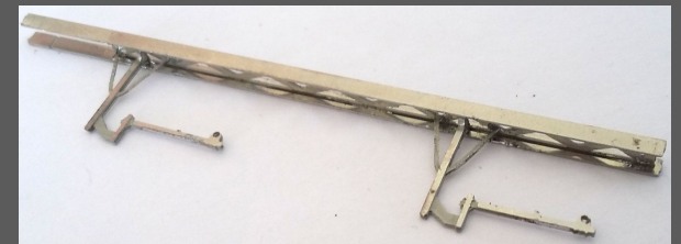
Befestigte Fahrdrachthalterung unterhalb des Joches
