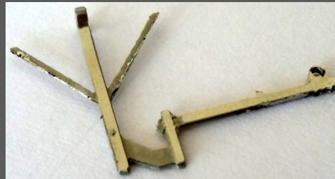
montierter unterer Fahrdrachtaufhänger
