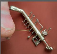
Nun wird ein 0,5 mm Draht in Laternenkopf eingeführt. (Länge Draht ca. 10,3 mm). Bei mehreren Laternen müssen die Drähte gleich lang sein, da es sonst zu unterschiedlichen Höhen kommt.
