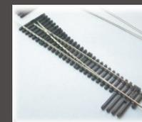
Backenschiene 2 eingesetzt
