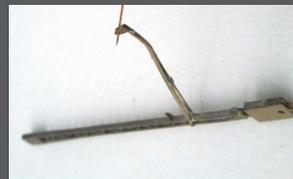
Oberer Ausleger für das Tragseil zusammengelötet und am Mast befestigt
